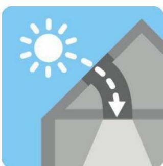
**Savitljivi** tunel je idealan za udaljenosti od 0.9 do 2 m mjereno od krova do stropa.
