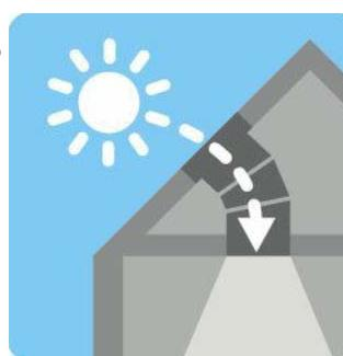
**Nesavitljivi** tunel je idealan za udaljenosti od 0.9 do 1.7 m mjereno od krova do stropa; s produžnim elementima do 6 m.
